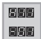
**Histéresis del corte 1:** va de  $-50^{\circ}\text{C}$  a  $50^{\circ}\text{C}$
