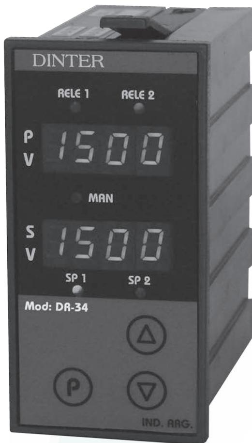
El controlador toma la señal del sensor, la acondiciona y amplifica, para luego compararla con el valor de referencia, de acuerdo al resultado obtenido envía una señal analógica de corriente 4-20 mA al motor modulante para abrirlo o cerrarlo. Esta apertura o cierre se realiza en forma proporcional a la diferencia existente con la referencia.
